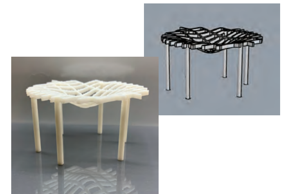
3Dプリンターで作成した模型(左)と、Rhinocerosで作成した3Dモデル(右)
